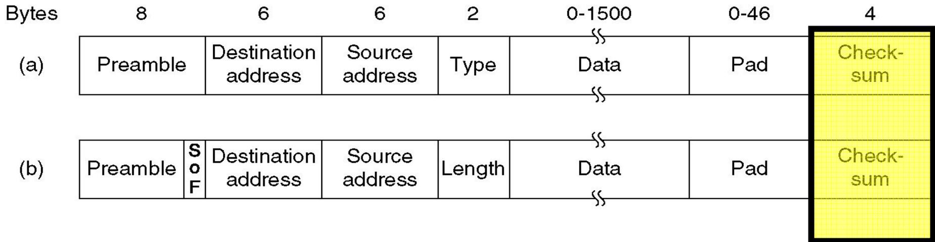
Il Campo Checksum o Frame Check Sequence (FCS) contiene un valore di 4-bytes di cyclic redundancy check (CRC).
