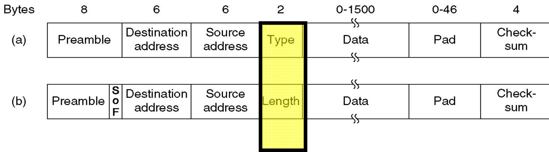
Il campo Ethernet *Type* specifica il protocollo superiore trasportato (> 1536 0x600 esadecimale)
